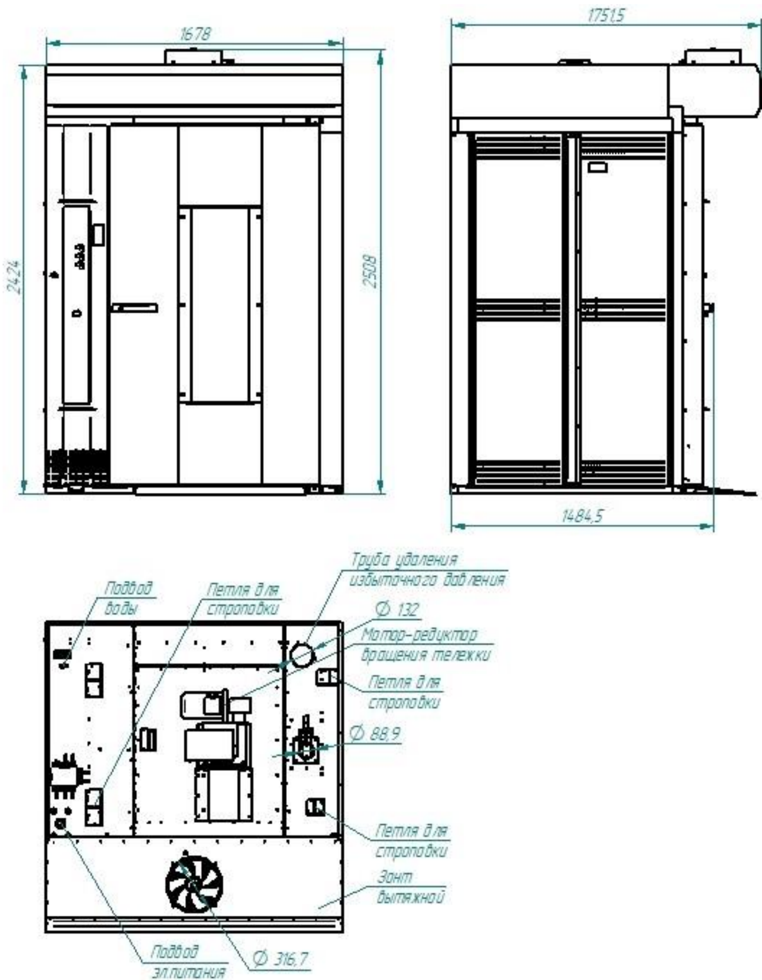
Рис.1. Ротационный пекарский шкаф РПШ-18-8-6ШР, РПШ-18-8-6МР (РПШ-18-8-6ЛР)
